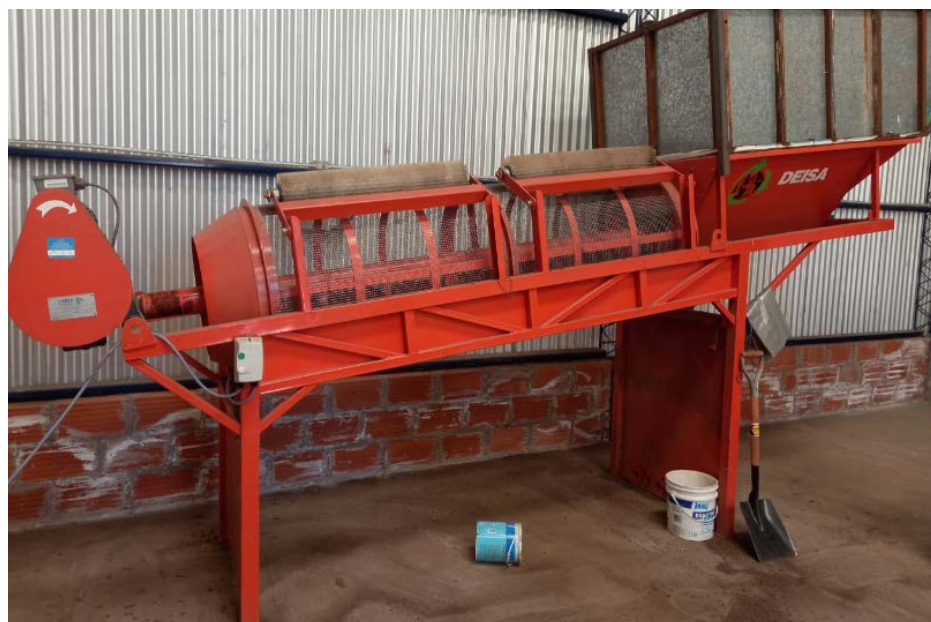
Trommel que utilizan en el vivero de Argerich, en el municipio de Villarino, para tamizar el compost que producen a partir de residuos verdes. Fuente: propia.
