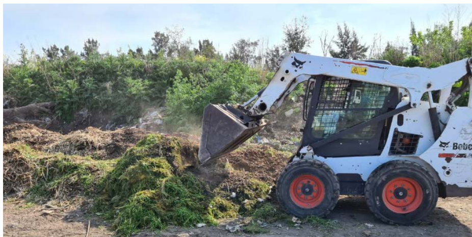
Conformación de pilas mezclando chips de podas con pasto del mantenimiento de espacios verdes del municipio de Pilar. Fuente: propia.
