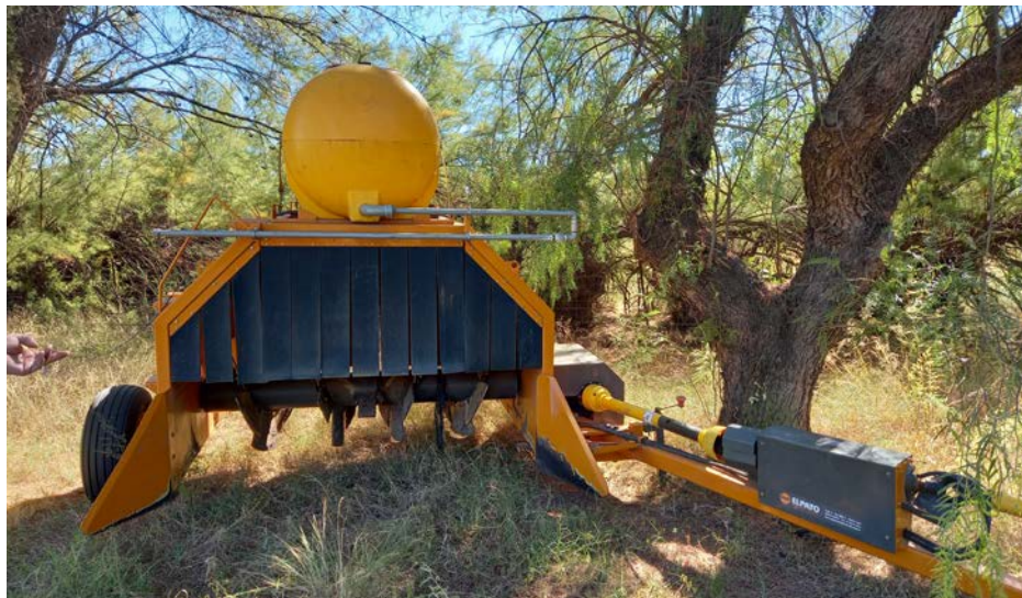
Volteadora de compost a tracción, industria nacional, utilizada en el vivero de Argerich, municipio de Villarino. Fuente: propia.
