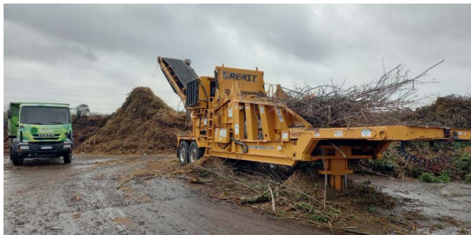
Chipeadora reduciendo podas en el Ecopunto del municipio de Avellaneda. Fuente: propia.
