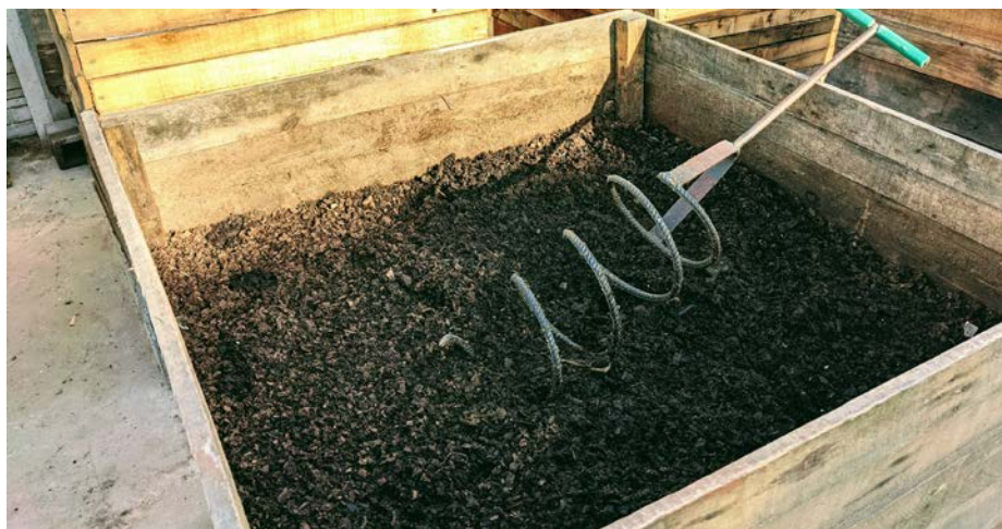
Aireador tipo "sacacorcho" fabricado por una cooperativa de recuperadores urbanos en Berazategui. Fuente: cortesía del municipio.
