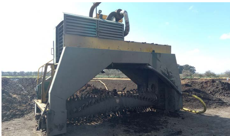
Volteadora de compost autopropulsada utilizada en una planta de tratamiento privada en Exaltación de la Cruz. Fuente: propia.
